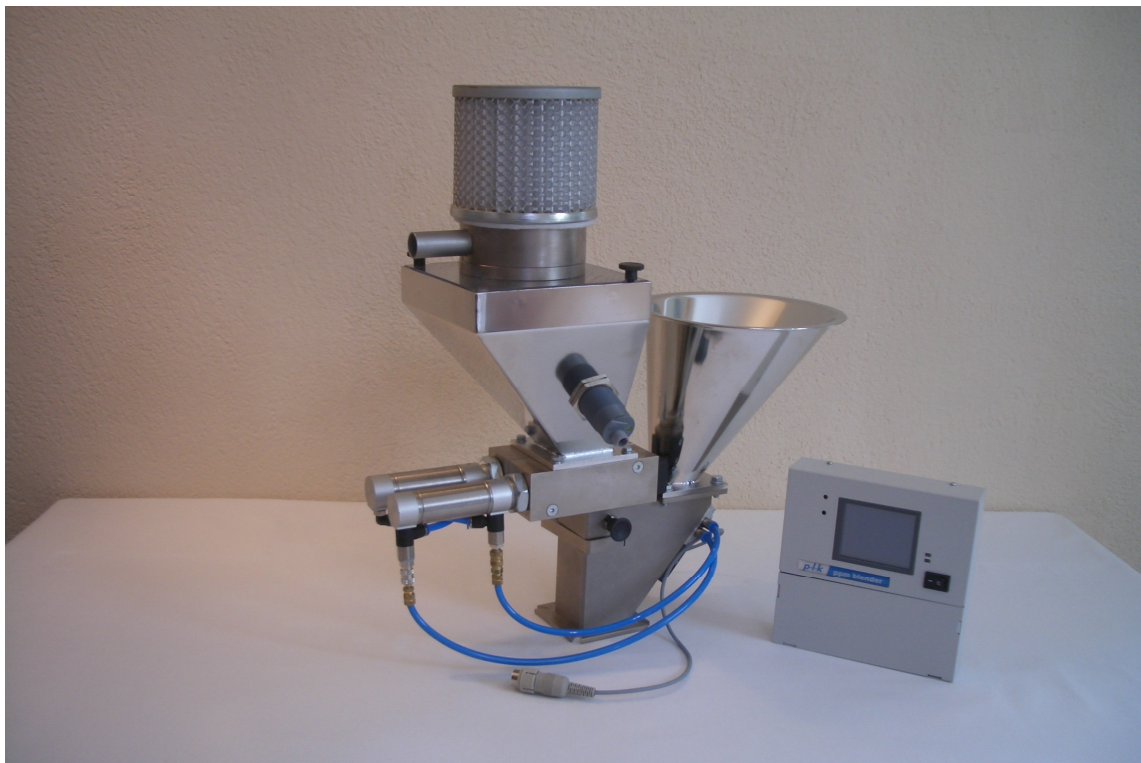
ppm blender AD mit Steuerung ST01 und Druckluftförderer ppm loader S
