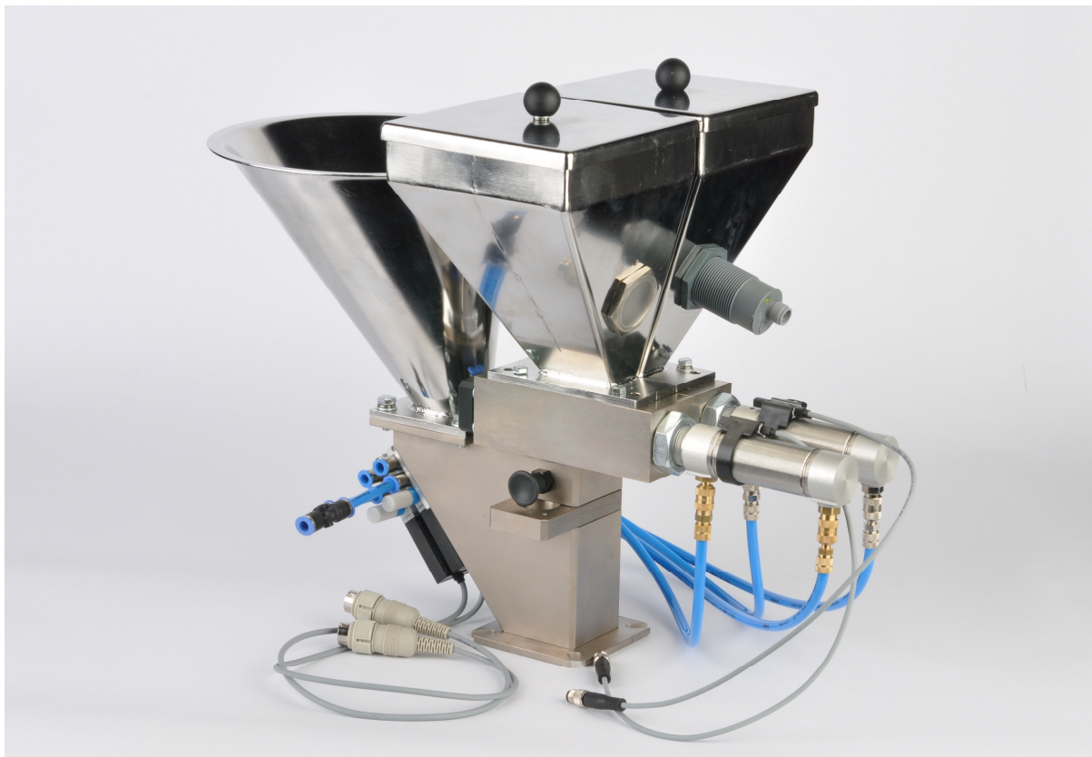
ppm blender AA mit Füllstandssensor und 2 x Näherungsinitiator
